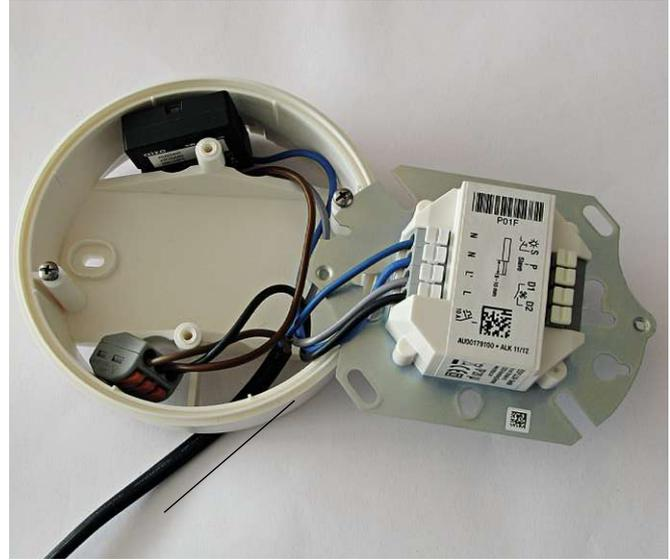
**Bild 40:** Geöffneter Präsenzmelder mit eingebauter SW-AKM220
