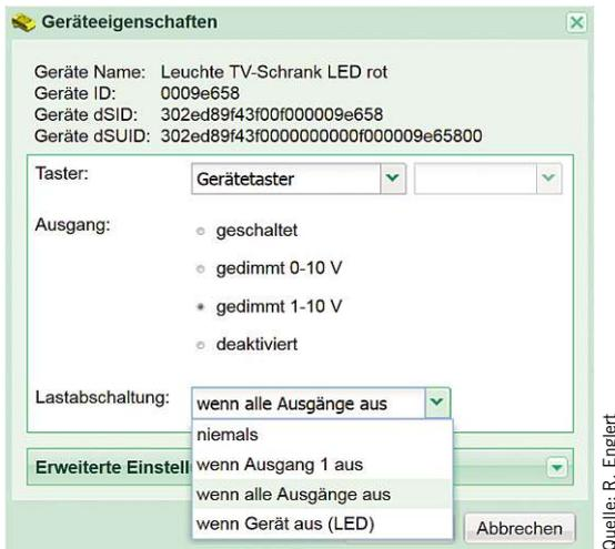
**Bild 22:** Konfiguration der Geräteigenschaften eines Kanals des GE-UMV200
