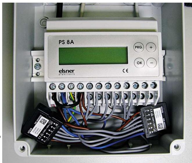
**Bild 37:** Anschluss der Digitalstrom-AKM-Klemmen an eine Wetterstation
