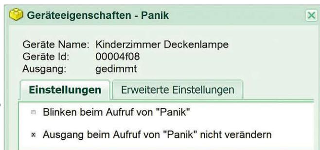
**Bild 13:** Einstellen der Panikfunktion am Beispiel einer Deckenleuchte
