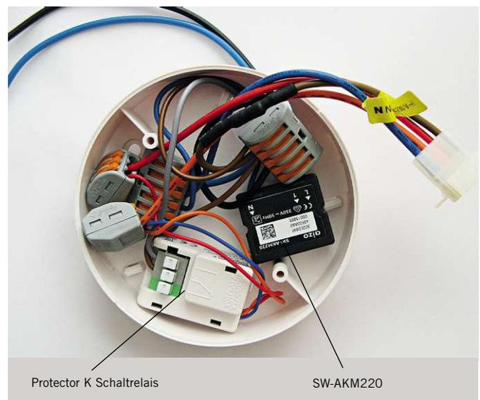
**Bild 38:** Rauchmelderanschluss – der Stecker rechts dient zur Verbindung
