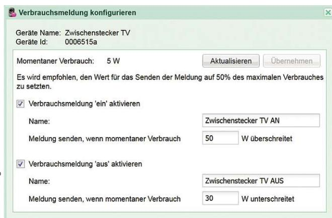
**Bild 19:** Einstellen der Verbrauchsmeldung des Zwischensteckers auf einen angeschlossenen Fernseher
