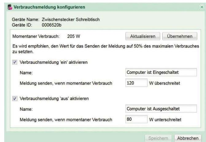
**Bild 52:** Konfiguration der Verbrauchsmeldung des Zwischensteckers SW-ZWS200-F
